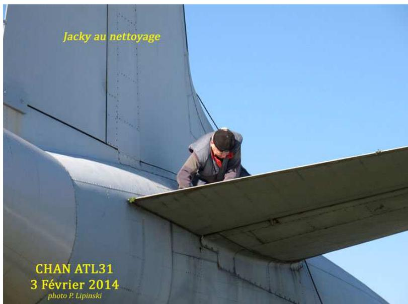
Et pendant ce temps là, Jacky a entrepris de « débroussailler » l'interstice entre gouverne de profondeur et fuselage pour extraire les branchages utilisés par les oiseaux pour construire leur nid ! Sans doute faudra-t-il prévoir un grillage ou un dispositif de colmatage pour boucher l'interstice ouvert.
