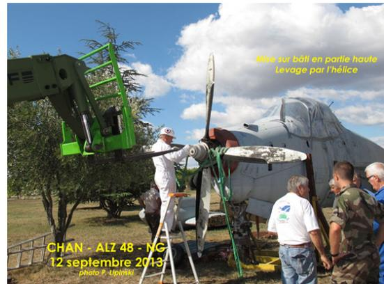
Ensuite, l'ensemble partie avant solidaire du bâti est soulevé par levage du bâti pour le positionner sur des palettes et atteindre la bonne hauteur d'alignement.
