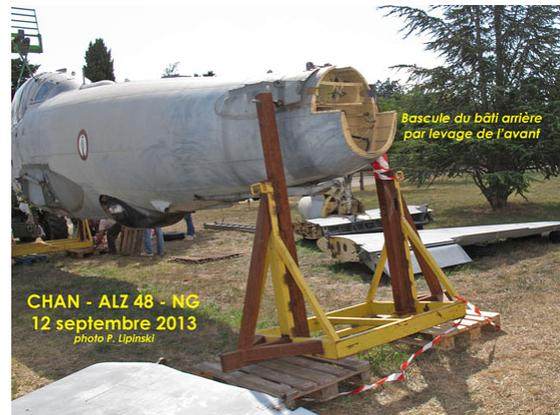
Opération délicate en raison, au moment du levage, d'un transfert de poids longitudinal qui a fait pencher le bâti arrière, heureusement en deçà de sa limite de basculement.
